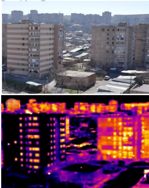
Նկար 10.5. ՄԱԶԾ/ԳԷՖ և քաղաքապետարանի համատեղ պիլոտային նախագծով ջերմաարդիականացված շենքը ցերեկային և ինֆրակարմիր տեսքով և շենքի էներգետիկ բնութագրերը ամփոփող էներգաարդյունավետության սերտիֆիկատ
