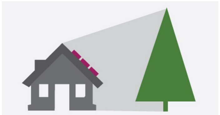
Նկար Միջավայրի/առարկաների ստվերի ազդեցությունը ՖՎ համակարգի վրա
